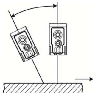
In presenza di sfondi che hanno un movimento scorrevole, soprattutto quando la loro superficie è scura o con caratteristiche riflettenti, è utile in fase di installazione montare il sensore inclinato rispetto al piano orizzontale con un angolo massimo di 30°, come mostrato in figura.
