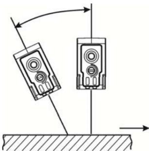
En présence de fonds qui ont un mouvement coulissant surtout quand leur surface est sombre ou a des caractéristiques réfléchissantes, il est utile en phase d'installation, de montrer le détecteur dans une position inclinée par rapport au plan horizontal avec un angle maximal d' 30° comme indiqué sur l'illustration.
