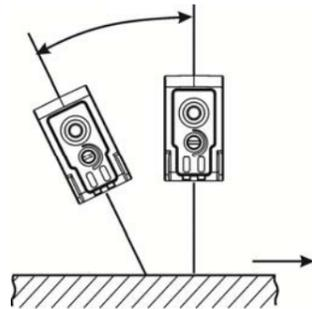
Bei Vorhandensein von Hintergründen mit einer laufenden Bewegung, vor allem bei dunkler Oberfläche oder mit reflektierenden Eigenschaften, kann es nützlich sein in der Installationsphase einen Sensor zu montieren, der mit einem maximalen Winkel von 30° geneigt zur horizontalen Oberfläche steht, wie auf der Abbildung dargestellt.
