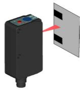
如果 READY LED 长亮, 则表示采集成功。如果 READY LED 快速闪烁, 则采集因对比度不足而失败。按下 SET 按钮, 传感器返回到之前的设置。从头开始重复该步骤。示教状态可以在 IO-Link 参数“TI Result”上读取。
