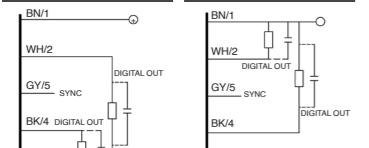
In caso di carico misto, resistivo e capacitivo, la massima capacità ammessa (C) è di 0,1  $\mu$ F per tensione e corrente di uscita massime.
