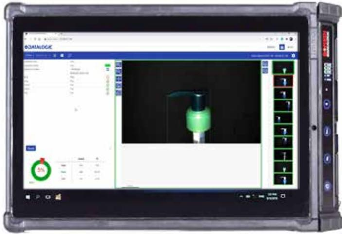
CPM 和 SDK 新增了一种新型监视器，即智能相机监视器 (SCM)，可立即访问探测结果、统计数据 和参数，并可通过任何能够运行网络浏览器的设备进行图像诊断
