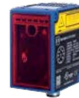
长量程传感器，采用了漫反射模式下的飞行时间技术原理。现有两款型号可选，高分辨率和高精度，可选的检测距离为10m和20m。图形显示型，具有可调节的示教按钮，且其金属外壳紧凑坚固。
